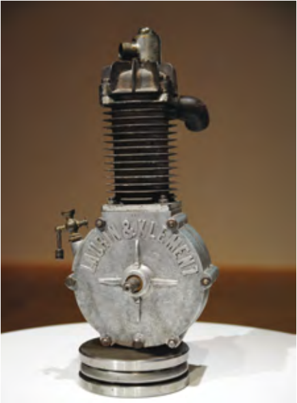
Motocyklový motor Typ 1 1/4 hp s objemom 211 cm³ z roku 1899 s výrobným číslom 161. Továrňou súčasne predstavila aj slabší motor Typ 1 1/4 hp.
