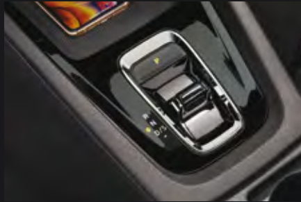
Na ovládanie automatickej prevodovky DSG sa používa minimalizovaný elektronický ovládač umiestnený medzi sedadlami.
