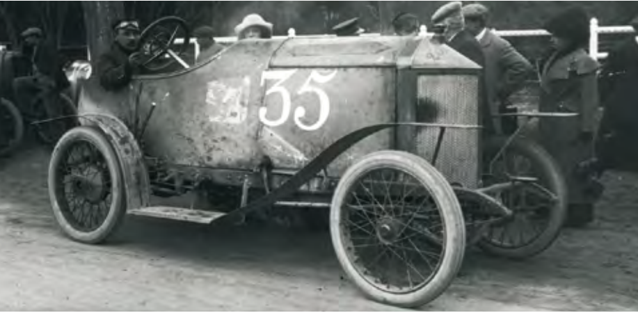
Radový štvorvalec s objemom 5 672 cm³ a výkonom 100 k s ventilovým rozvodom OHC pre závodný špeciál FCR. Dôvodom nevidaného zdvíhu boli vtedajšie medzinárodné predpisy pre jednotlivé kategórie, jeden z nich obmedzoval vrtanie na ø 85 mm.
