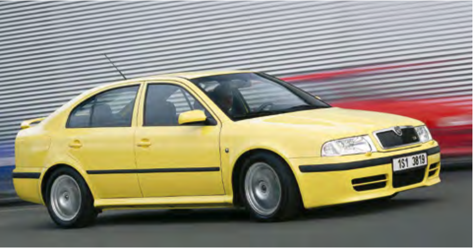
Športovo ladená OCTAVIA RS sa začala vyrábať na prelome rokov 2000/2001 a jej zážihový prepliňovaný motor s objemom 1,8 litra disponoval výkonom 180 k. Auto zrýchlovalo z 0 na 100 km/h za 7,9 s a dosahovalo rýchlosť 235 km/h.
