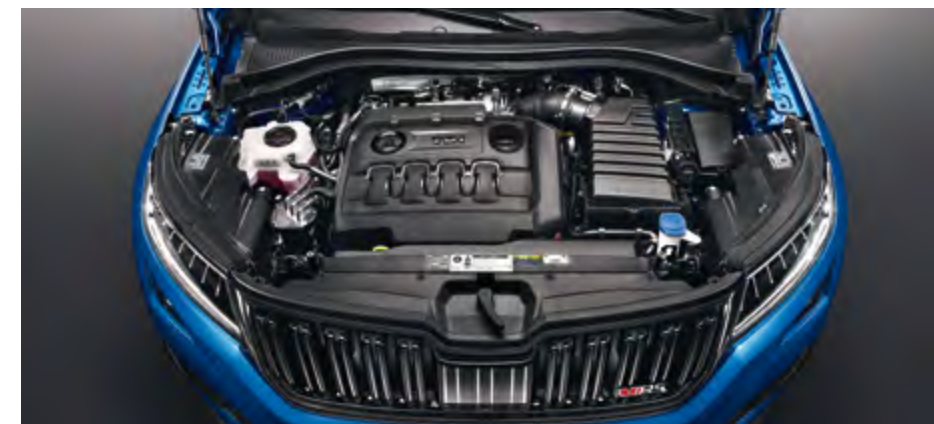
Unikátny vznetrový motor preplňovaný dvoma turbodúchadlami zaujme výkonom 176 kW (240 k) a krútiacim momentom 500 Nm.
