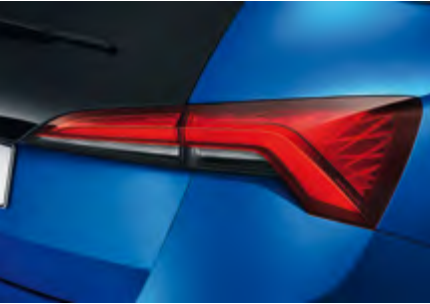
Koncové svetlá môžu byť na želanie vybavené dynamickými ukazovateľmi smeru jazdy, samozrejme využívajúcimi LED.
