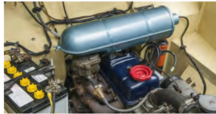
Motor s typickým filtrom nasávania a krytom rozvodov už na prvý pohľad nesie pečať mladoboleslavskej automobilky.
