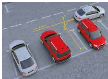
Automatický parkovací asistent nového modelu ŠKODA Octavia dokáže zaparkovať nielen medzi pozdĺžne stojace vozidlá, ale tiež medzi priečne zaparkované automobily.
