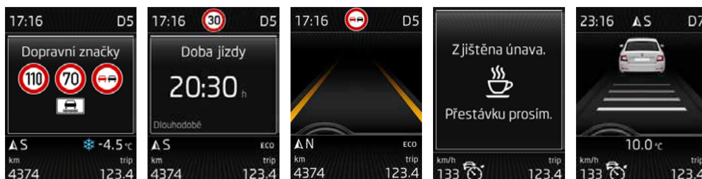
Na farebnom displeji Maxi DOT, umiestnenom medzi prístrojmi, sa zobrazujú informácie takmer všetkých asistenčných systémov novej generácie modelu ŠKODA Octavia a ŠKODA Octavia Combi.
