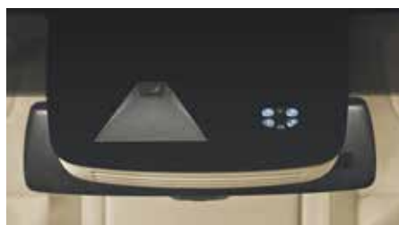
Čelná kamera umiestnená v module spätného zrkadla sleduje situáciu pred vozidlom. Asistenčné systémy jej obraz vyhodnocujú podľa vlastných potrieb.
