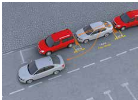
Automatický parkovací asistent nového modelu ŠKODA Octavia dokáže zaparkovať nielen medzi pozdĺžne stojace vozidlá, ale tiež medzi priečne zaparkované automobily.
