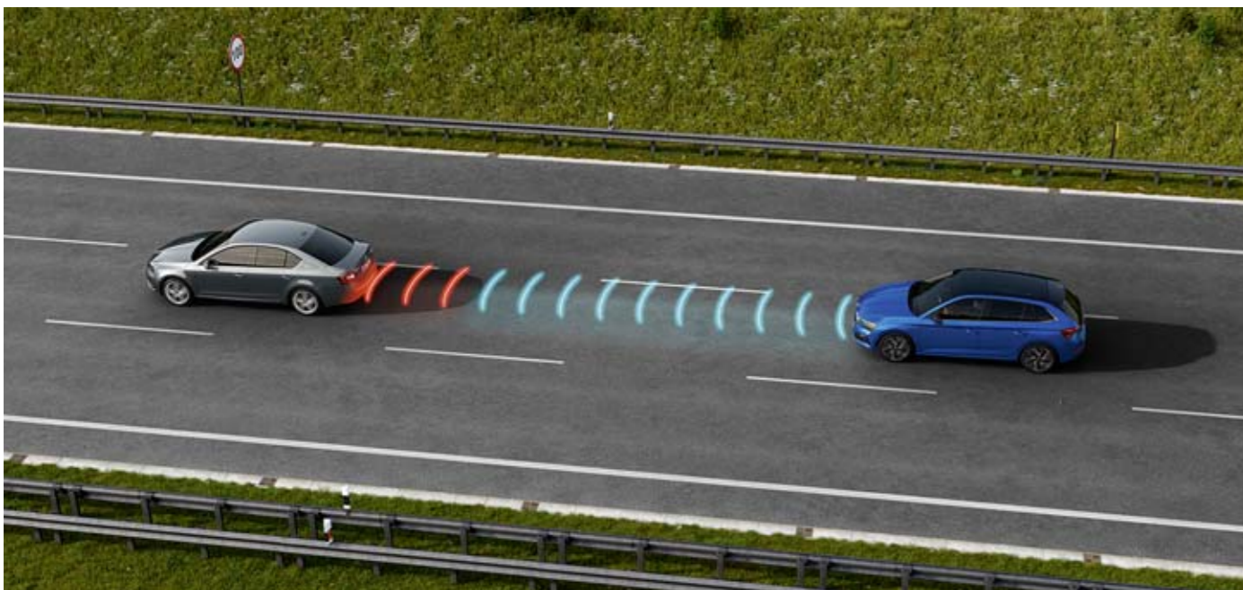
ADAPTIVE CRUISE CONTROL Nad rámec základnej funkcie tempomatu dokáže tento asistenčný systém pomocou radaru v mriežke chladiča udržiavať bezpečný odstup od vozidiel idúcich pred vami, a to až do rýchlosti 210 km/h.
