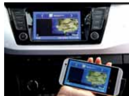
Technológia MirrorLink™ umožňuje zrkadliť aplikácie zo smartfónu na displeji vášho audiosystému.
