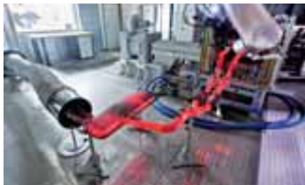
Skúška motora VR6 3,6 I pri maximálnom zatažení.
