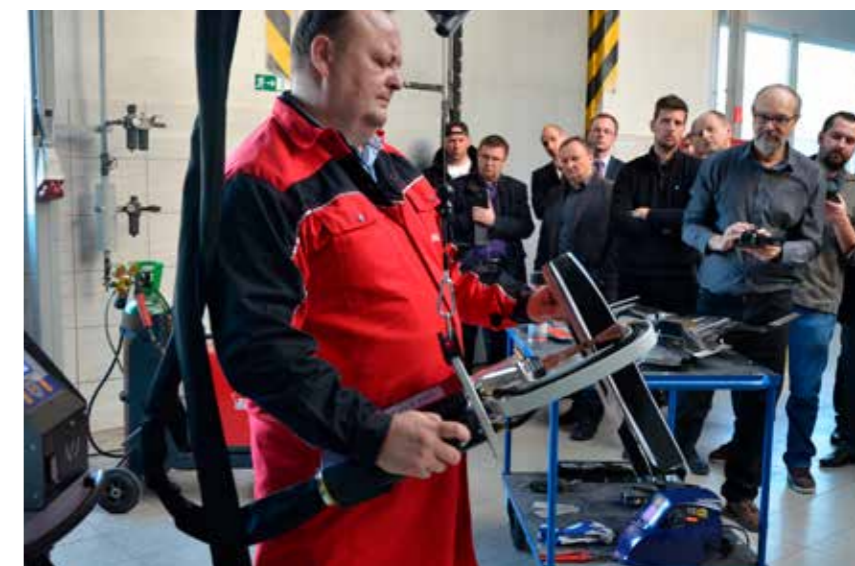
Prezentácia bodového zvarovania vysokopevnostných ocelí v klampiarskej dielni spol. PO CAR, ktoré sú použité vo vozidlách ŠKODA.
