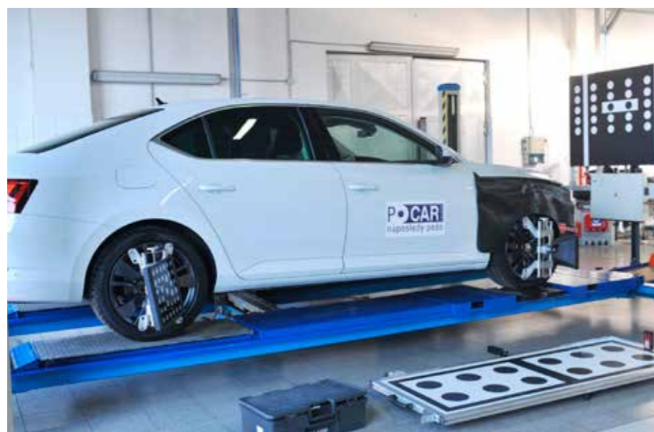
Špeciálne zariadenie na kalibráciu radaru a kamery, PO CAR.
