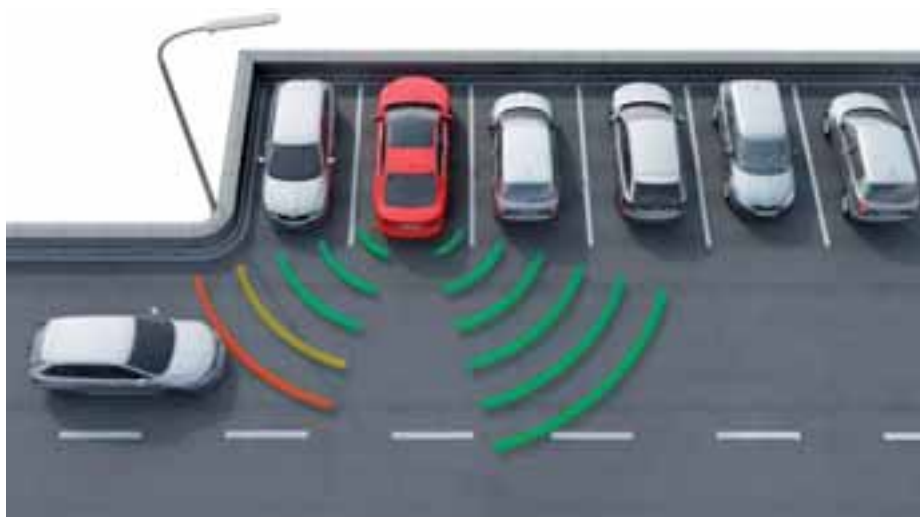
Asistent pre vycúvanie z parkovacieho miesta informuje o prítomnosti cudzieho vozidla šikmo za vozidlom. Na jeho identifikáciu slúžia ultrazvukové snímače.
