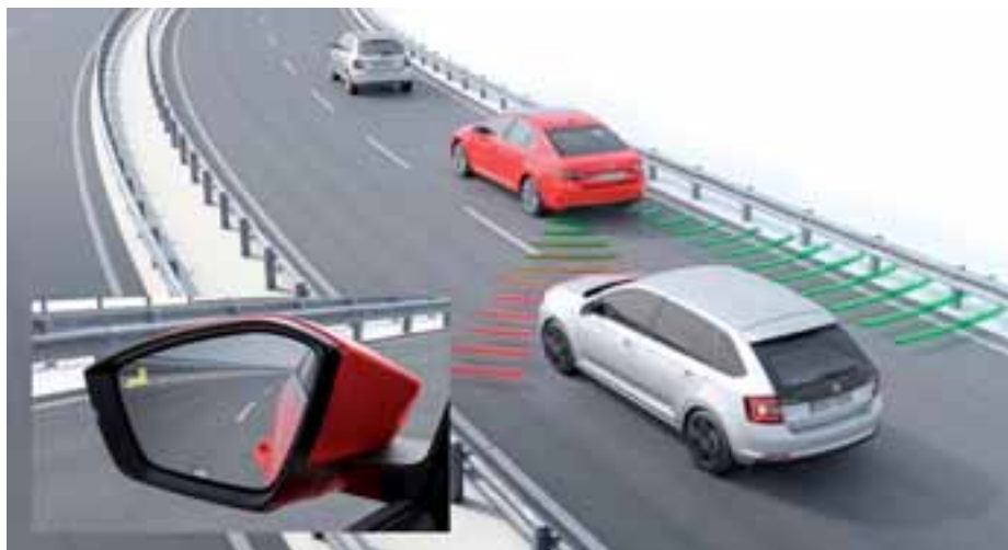
Novinkou ponuky značky ŠKODA je v novom Superbe systém monitorovania mŕtveho uhla spätných zrkadiel. Vodiča o prítomnosti vozidla v tomto priestore informuje kontrolka umiestnená v príslušnom zrkadle.
