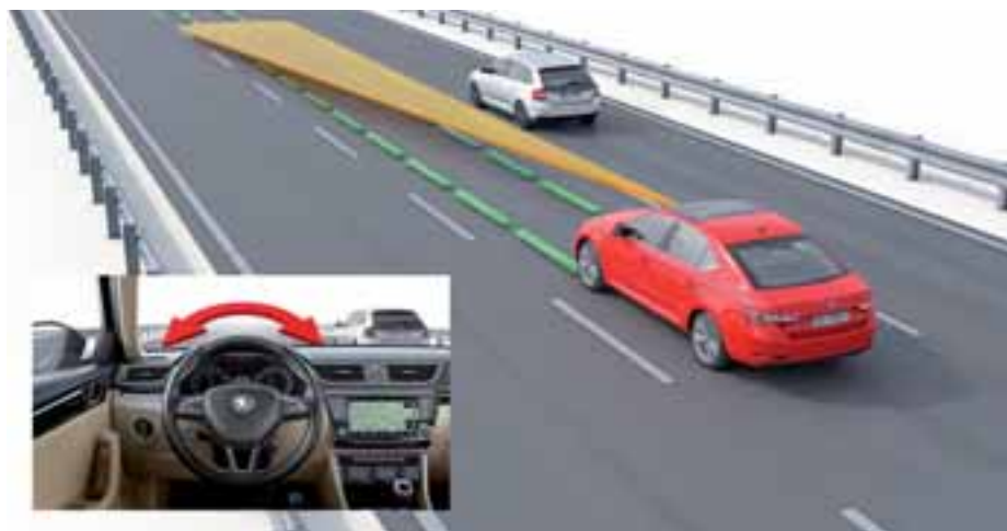
Systém udržiavania v jazdnom pruhu pomocou čelnej kamery a zásahov do riadenia pomáha vodičovi ísť uprostred jazdného pruhu. Ide o asistenčný systém, nie o systém automatického riadenia.
