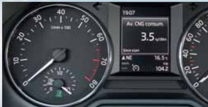
Rozsvietená zelená kontrolka na ukazovateli množstva plynu v nádržiach indikuje pri modeloch Octavia G-TEC a Octavia Combi G-TEC režim, keď vozidlo spaľuje CNG.
